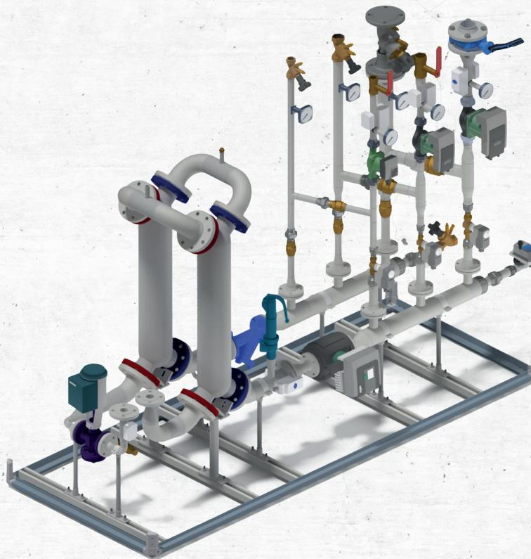
Die Ausführung für Übergabestationen von 100 kW bis über 1 MW kann flexibel nur als Wärmetauscherbaugruppe (inkl./exkl. Verteilerladepumpe), als Kompaktstation mit bis zu vier Heiz- und Lüftungsgruppen sowie Registerboiler oder bei Bedarf mit Schichtenspeicher oder Frischwasserstation aufgebaut werden.
