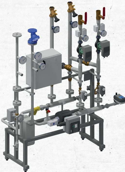
Ausführung für Übergabestationen von 10 kW bis 80 kW kann flexibel als Kompaktstation mit bis zu vier Heiz- und Lüftungsgruppen sowie Registerboiler oder bei Bedarf mit Schichtenspeicher oder Frischwasserstation aufgebaut werden.
